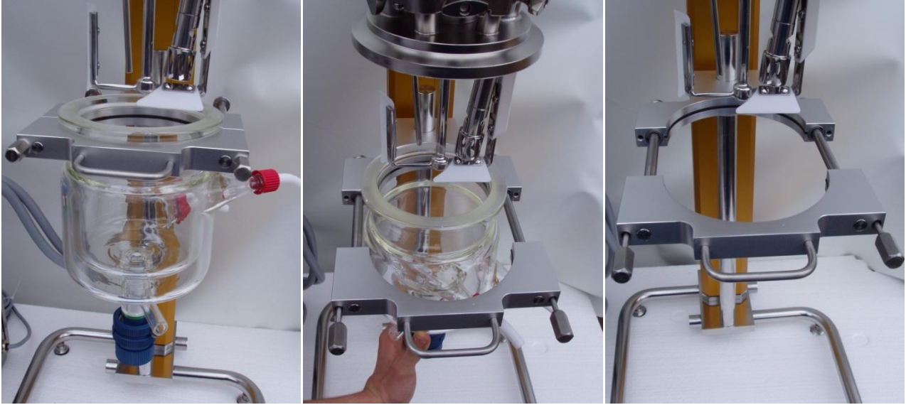
두 개의 고정 나사를 이용해서 쉽게 용기를 분리 및 장착
